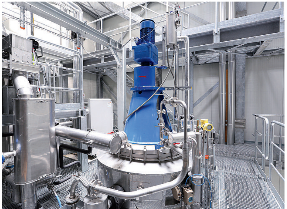
Mittels Kurzwegdestillation lassen sich Kontaminanten bei niedriger thermischer Belastung entfernen und wertvolle Mikronährstoffe bewahren. (Bild: Nutriswiss)
